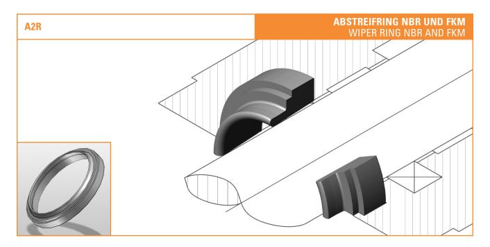
Der Abstreifring Profil A2R hat die Aufgabe, während der Einfahrbewegung der Kolbenstange das Eindringen von Schmutz zu verhindern. Dies wird durch seine spezielle Formgebung garantiert. Somit vermeidet er die Riefenbildung auf der Lauffläche, und verlängert die Standzeiten der Dichtungen. Die Formgebung der Abstreiflippe wurde speziell für den Einsatz in pneumatischen Anwendungen optimiert. Der Abstreifring Profil A2R kann somit auch bei trockener, ölfreier Luft eingesetzt werden.
