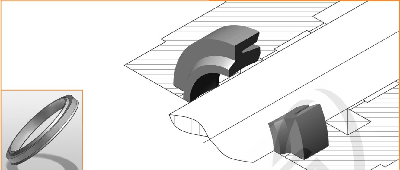
Der Doppelabstreifring Profil AYR hat die Aufgabe, während der Einfahrbewegung der Kolbenstange das Eindringen von Schmutz zu verhindern. Dies wird durch seine spezielle Formgebung mit scharf abgestochener Abstreifkante und einer zusätzlichen Dichtlippe auf der Mediumseite gewährleistet. Letztere sorgt für die Rückförderung des Restölfilms in das System. Somit vermeidet er die Riefenbildung auf der Lauffläche und verlängert die Standzeiten der Dichtungen.
