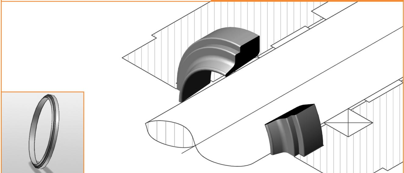
Der Abstreifring Profil A1R hat die Aufgabe, während der Einfahrbewegung der Kolbenstange das Eindringen von Schmutz zu verhindern. Dies wird durch seine spezielle Formgebung garantiert. Somit vermeidet er die Riefenbildung auf der Lauffläche, und verlängert die Standzeiten der Dichtungen.
