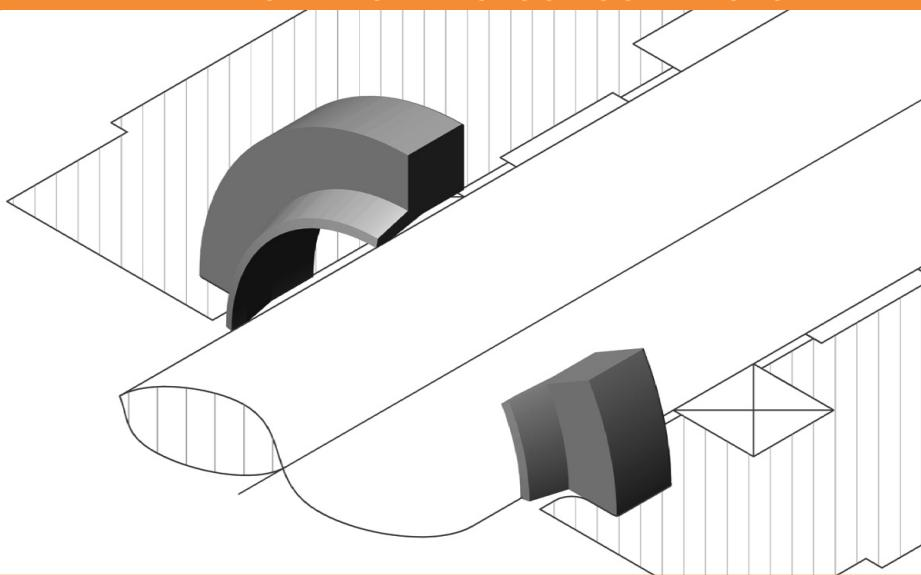
Der Abstreifring Profil A5R (HPU) hat die Aufgabe, während der Einfahrbe wegung der Kolbenstange das Eindringen von Schmutz zu verhindern. Dies wird durch seine spezielle Formgebung garantiert. Somit vermeidet er die Riefenbildung auf der Lauffl äche, und verlängert die Standzeiten der Dichtungen. Sein Übermaß im Durchmesser sorgt f ür den Festsetzen in der Nut und gewährleistet somit den Formenschluss am Au ßendurchmesser des Abstreifers.
