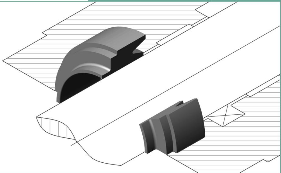
Das Pneumatik-Dicht-Abstreifelement Profil ELR vereint zwei Funktionen in einer Dichtung: Dichten und Abstreifen von Kolbenstangen kleiner Pneumatikzylinder und Ventilstößeln.
