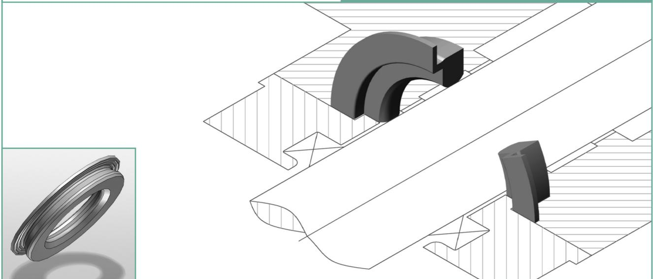
Ventildichtung für Schieberventile der Reihe ISO 5599
