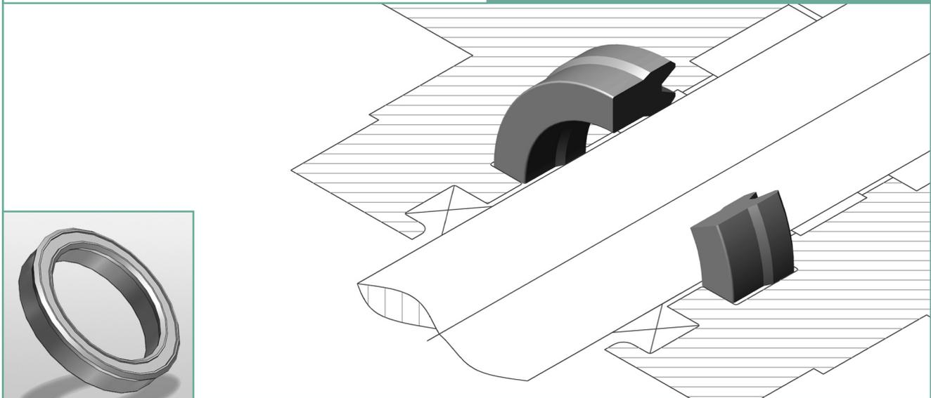
Die HPU Stangendichtung Profil GCR ist eine symmetrische Kompaktdichtung, die ohne Stützing eingebaut werden kann. Die Dichtlippe streift aufgrund ihrer radialen Vorspannung den Flüssigkeitsfilm intensiv ab. Dadurch wird bei Niederdruck oder druckloser Bewegung der Stange eine ausgezeichnete Dichtwirkung erzielt. Andererseits ist der hochfeste Polyurethan-Werkstoff auch in der Lage, hohe Drücke problemlos zu bewältigen.
