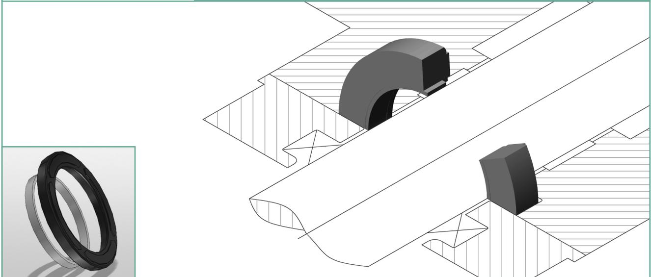
Das Profil JAR ist eine Elastomer Abdichtung für Kolbenstangen mit einem integrierten Gleitring. Durch diese Kombination vereint sie besonders gute Gleiteigenschaften mit einer hohen Dichtigkeit.
