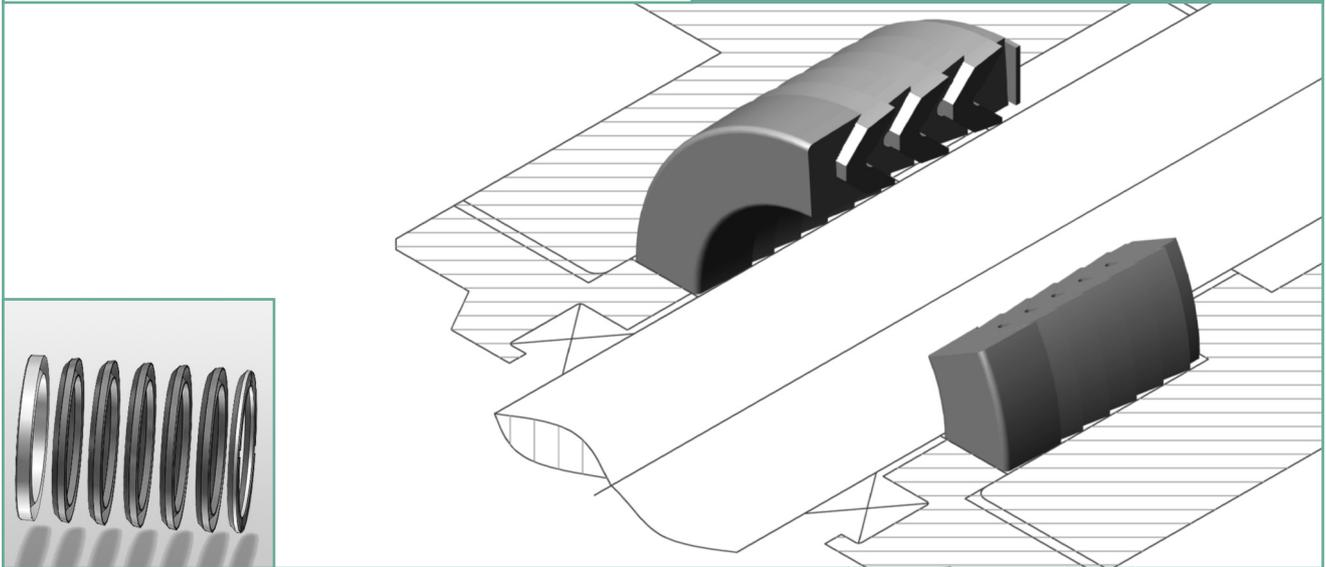
Der Stangendichtsatz M0S kann durch die Kombination von verschiedenen Einzelmanschetten auf eine, vom Standard abweichende Satzhöhe, aufgebaut werden. Im Rahmen einer kostengünstigen Prototypenfertigung läßt sich dieser Dichtsatz in nahezu allen Durchmessern und Materialien auf den Kundenwunsch anpassen. Für standard Abmessungen empfehlen wir die Stangendichtsätze M2S und M3S.
