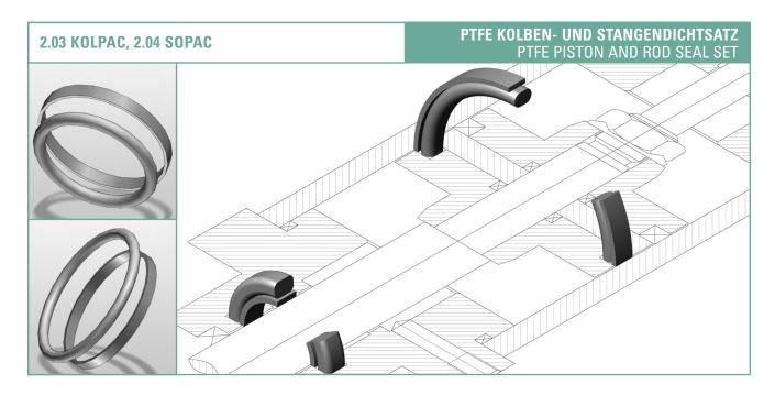
Kolpac (Kolbendichtung) und Sopac (Stangendichtung) sind wechselseitig wirkende Dichtelemente, bestehend aus einem O-Ring für die statische Anpressung und einem PTFE-Ring für die dynamische Abdichtung.
