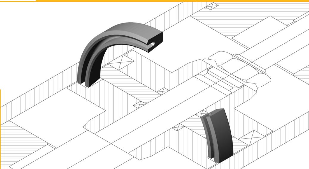
Die HPU Zylinderdichtung B7P ist ein Lippenring der mit Untermaß am Innendurchmesser gefertigt wird. Hierdurch ergibt sich ein Festsitz der statischen Lippe im Nutgrund des Kolbens. Diese Dichtung verwendet man für den Einsatz in der Hochdruckhydraulik, wenn aufgrund der Einsatzparameter gewebeverstärkte Dichtungen nicht mehr ausreichend sind.
