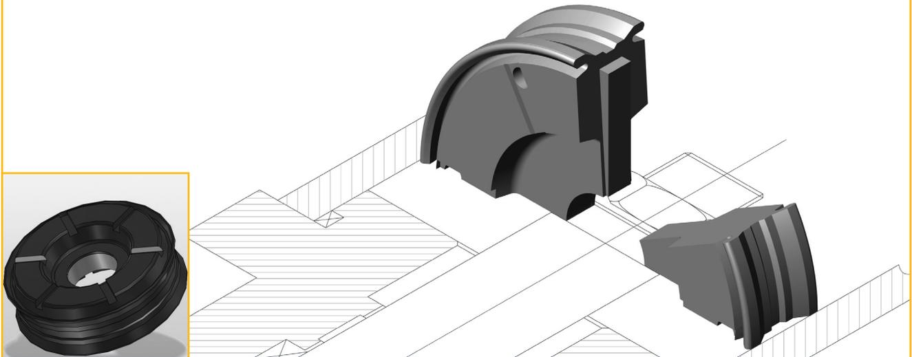
Der Pneumatik-Komplettkolben Profil DPP ist ein doppelt wirkender Kompaktkolben mit integrierter Endlagendämpfung. Bei diesem Profil wurde eine Metallscheibe in NBR einvulkanisiert, die als Stützteil dient. Dieses Profil vereint drei Funktionen in sich: Dichten, Führen und Dämpfen.
