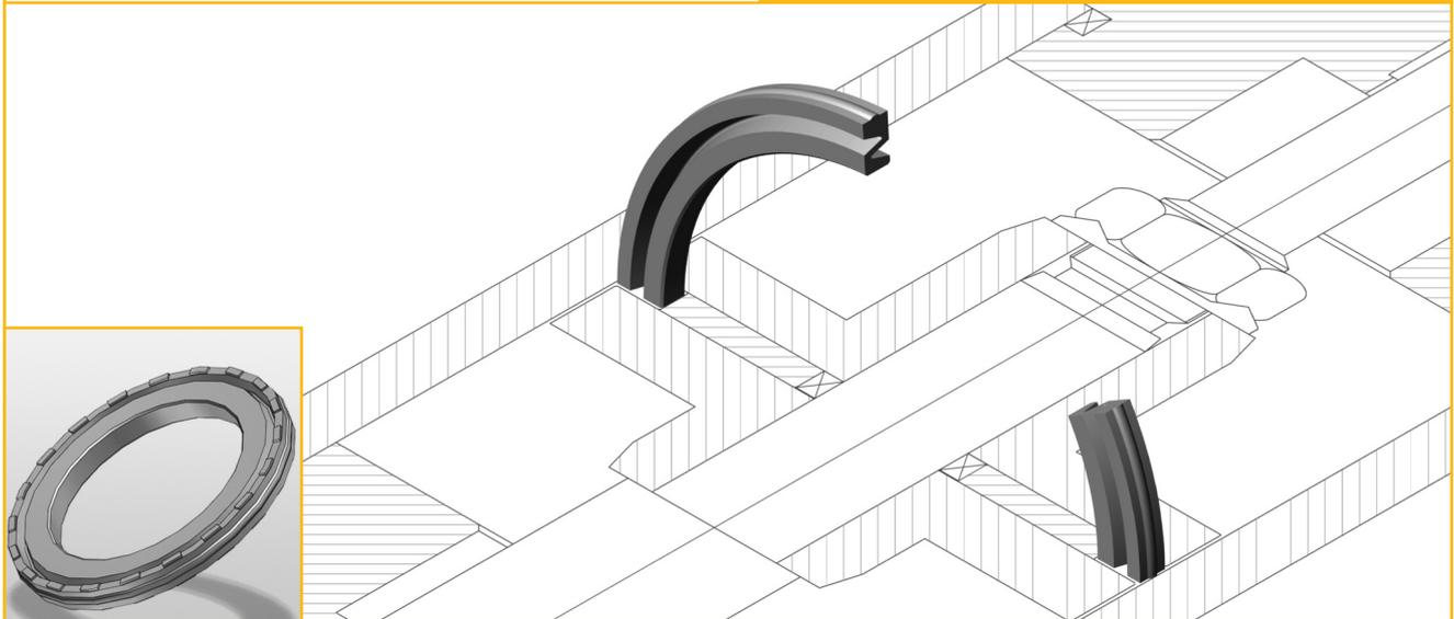
Das Profil PZP ist eine Elastomer-Zylinderdichtung, die für beidseitig druckbeaufschlagbare Kolben in der Pneumatik entwickelt wurde. Durch zwei sehr kleine Dichtkanten und dem dazwischen angebrachten Schmierdepot zeichnet sie sich durch extreme Leichtgängigkeit aus.
