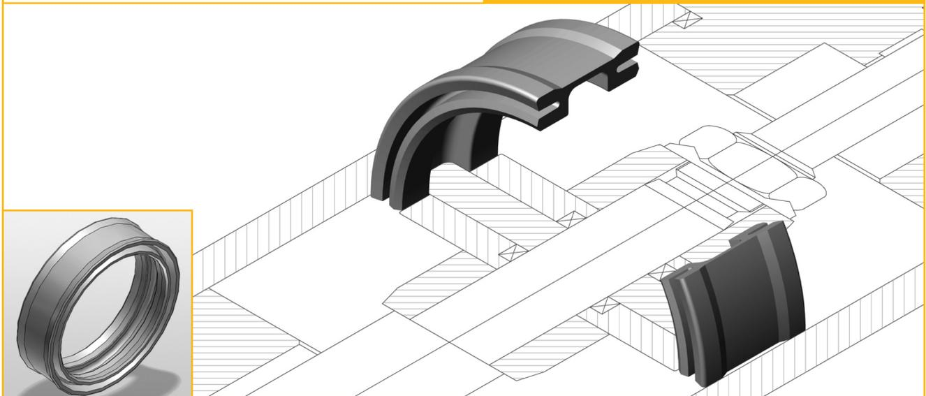
Das Profil Z5P vereint in sich zwei Funktionen, das Dichten und das Führen. Die Kolbendichtung besteht aus zwei entgegengesetzt gerichteten Nutringen mit einem dazwischen liegenden Führungssteg und ist somit für wechselseitig beaufschlagte Kolben einsetzbar.
