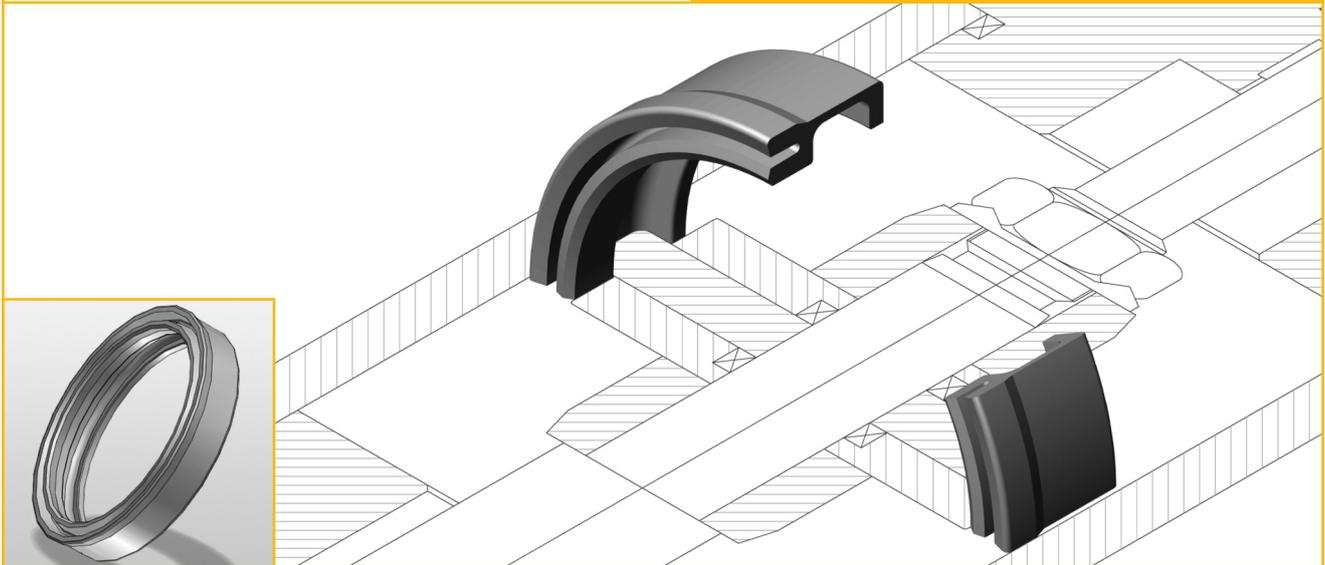
Das Profil Z7P vereint die Funktionen Dichten und Führen miteinander. Die Zylinderdichtung ist einseitig mit Druck beaufschlagbar und daher schmäler als das doppelt beaufschlagbare Profil Z5P. Diese platzsparendere Ausführung kann je nach Konstruktion hier einen Vorteil bringen.
